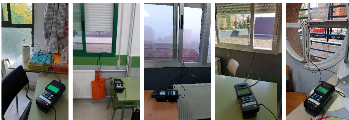
Medición del nivel de CO 2 en el exterior de las aulas
